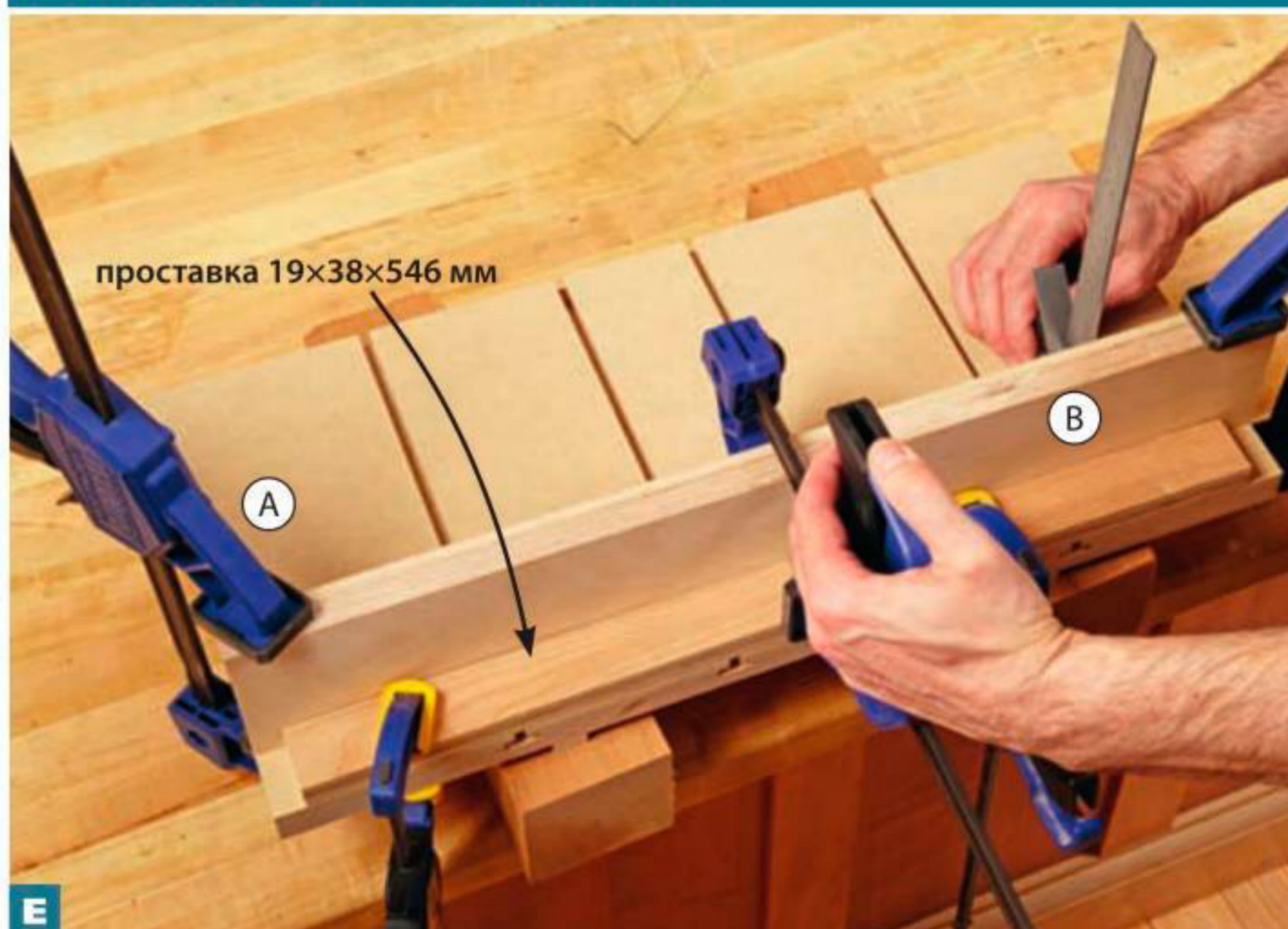
E Расположив упор B/D пазом вперед, приклейте его к основанию A/C и прижмите струбциной к проставке, выровненной с задним краем основания. Проверьте прямоугольность сборки.
