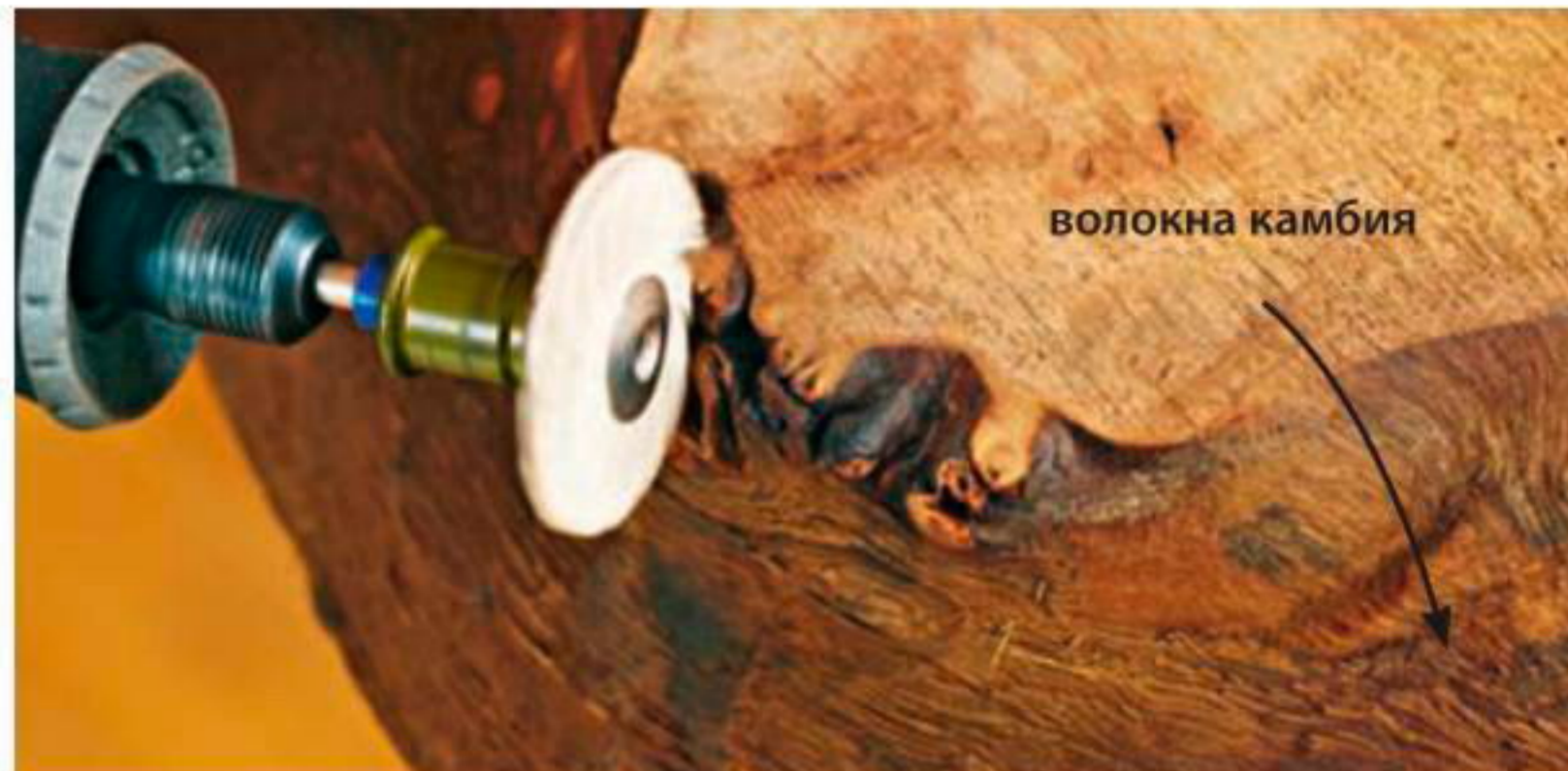
Чистку углублений и рельефных мест удобнее делать небольшими лепестковыми дисками.
