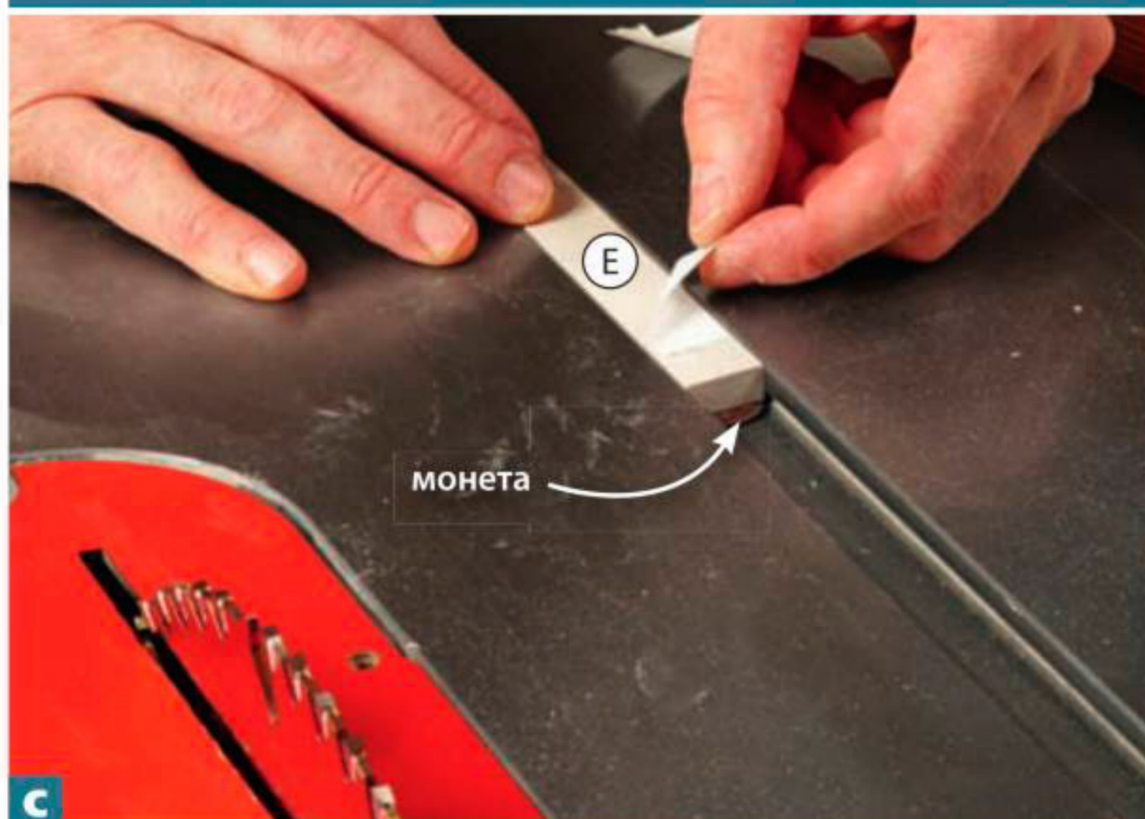
C Положите на дно каждого паза небольшие монетки, чтобы рейки-ползуну E слегка выступали над поверхностью пильного стола. Наклейте на верхние грани реек по два отрезка двухстороннего скотча.
