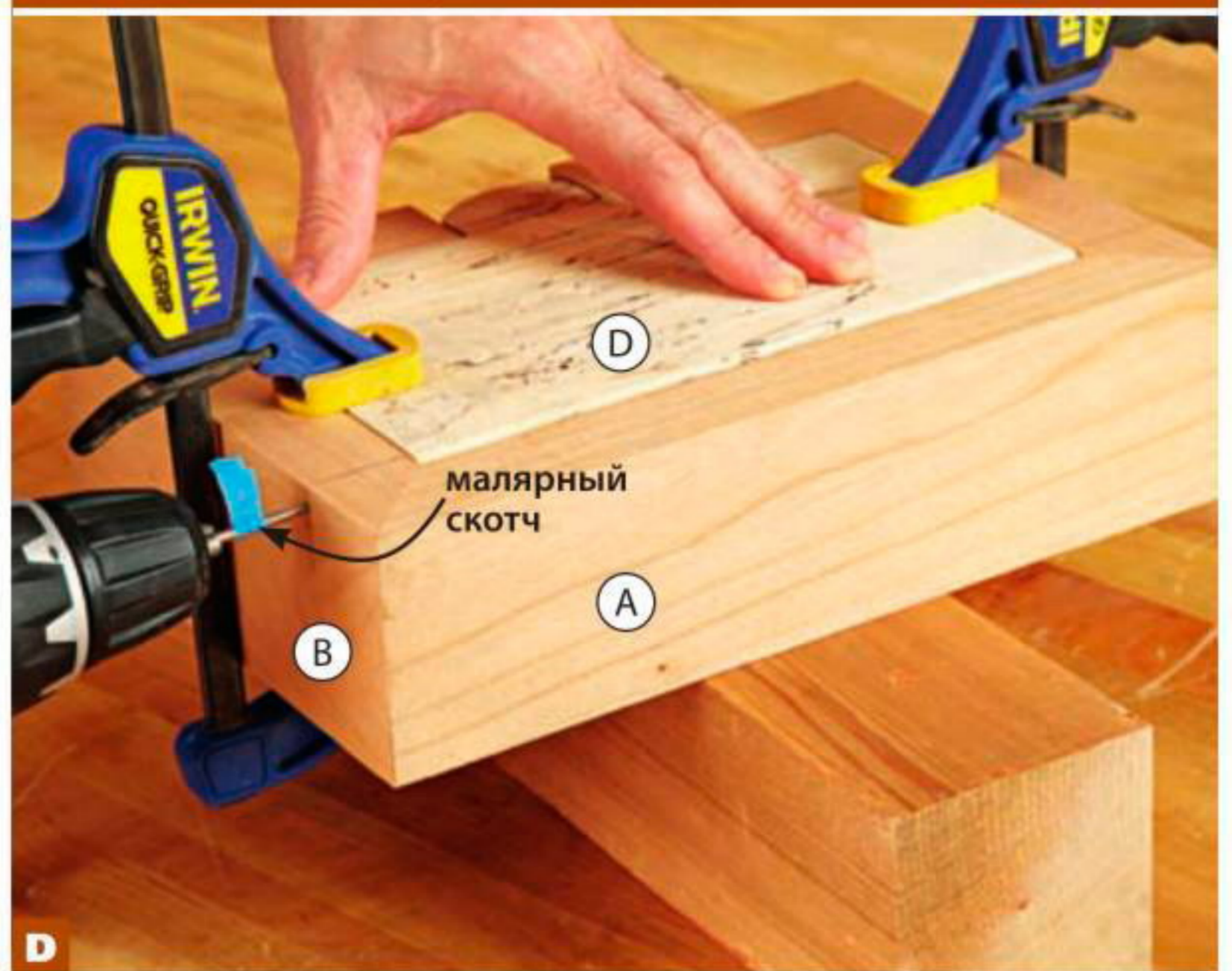
Д Закрепите крышку D струбцинами, чтобы она не сдвинулась при сверлении отверстий для осевых штифтов. Флажок из малярного скотча служит индикатором глубины отверстия.
