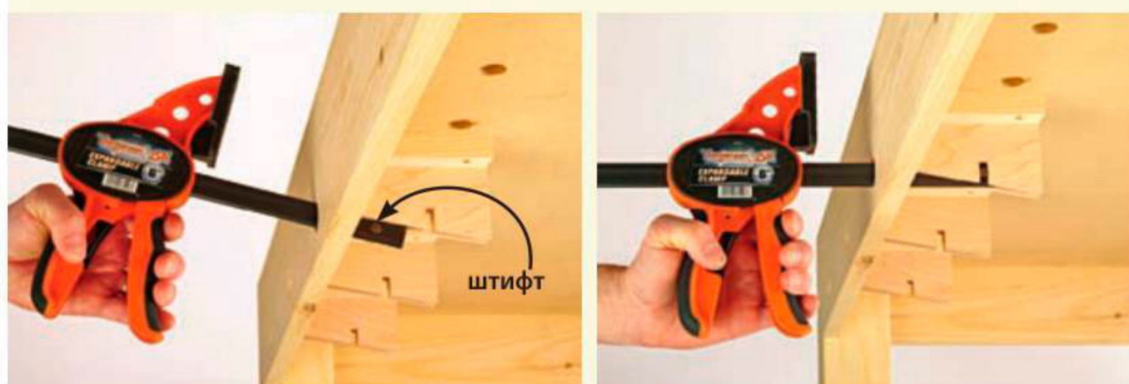
Вставив рейку струбцины в отверстие царги и заведя штифт в прорезь блока, вы сможете зажать доску между подвижной губкой струбцины и верстачным упором.
