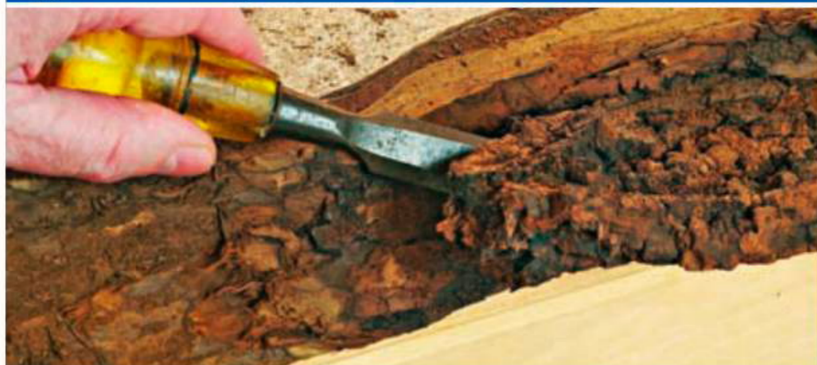
Чтобы удалить большую часть коры, аккуратно подденьте ее стамеской. Направляйте инструмент вдоль кромки, чтобы не оставить следов на древесине.
