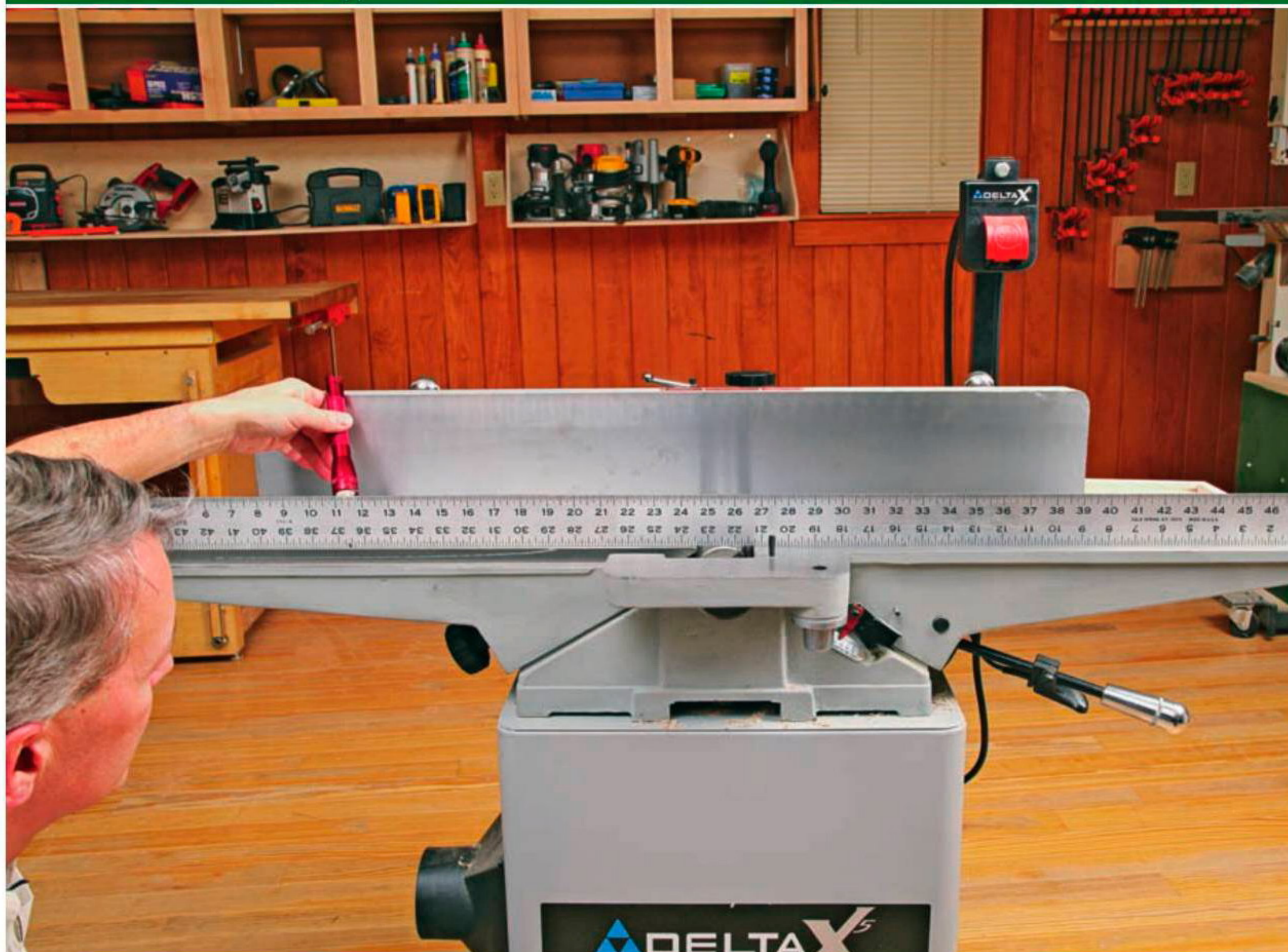
Направив свет фонарика на заднюю сторону линейки-правила, вы легко увидите зазоры, требующие устранения.
