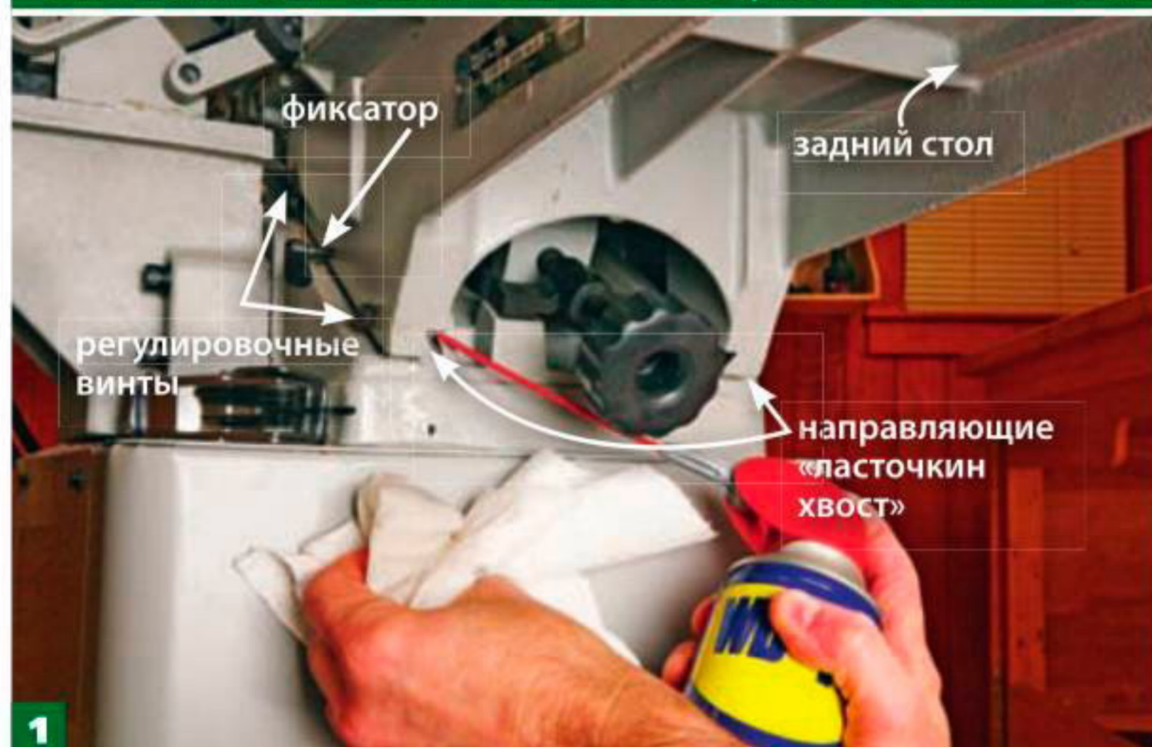
1 Ослабьте регулировочные винты и фиксатор стола. Нанесите WD-40 или похожую смазку между поверхностями направляющих с обеих сторон, чтобы растворить старую смазку.
