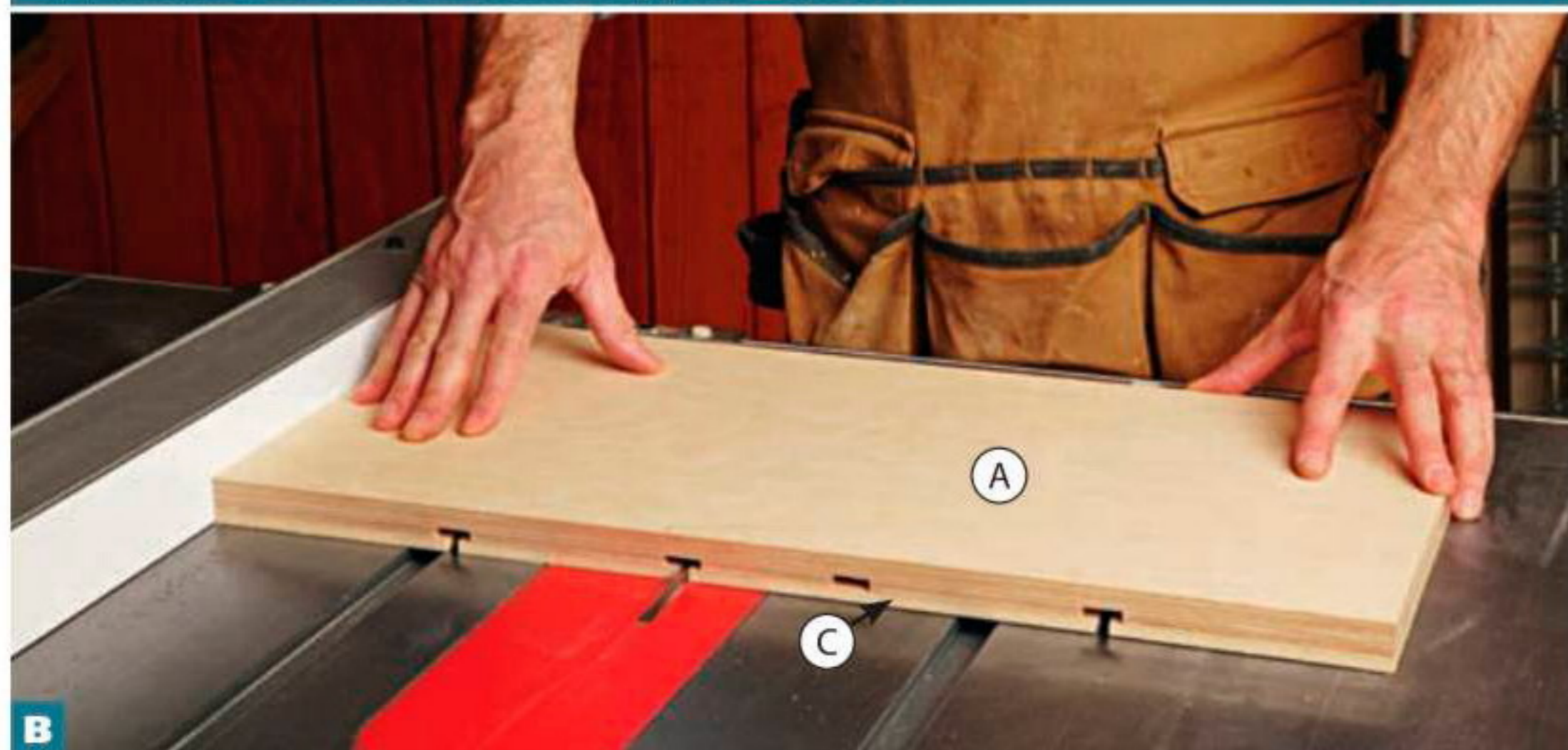
В Выравнивайте основание А/С и упор В/Д относительно пазового диска с помощью продольного (параллельного) упора. Сделайте по центру пазов прорези шириной 6 мм только в накладках из оргалита.
