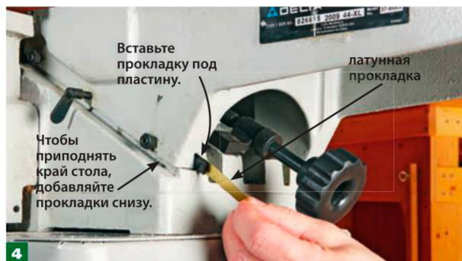
4 Отрежьте тонкую латунную полоску, длина и ширина которой такие же, как у пластины, и вставьте ее под пластину. Если требуется, добавьте еще несколько латунных прокладок.
