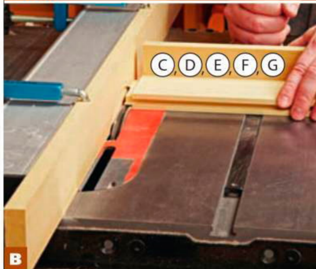
В Установите продольный упор так, чтобы деревянная накладка едва касалась зубьев диска. Сформируйте одну сторону шипа, переверните заготовку и сделайте еще один проход.
