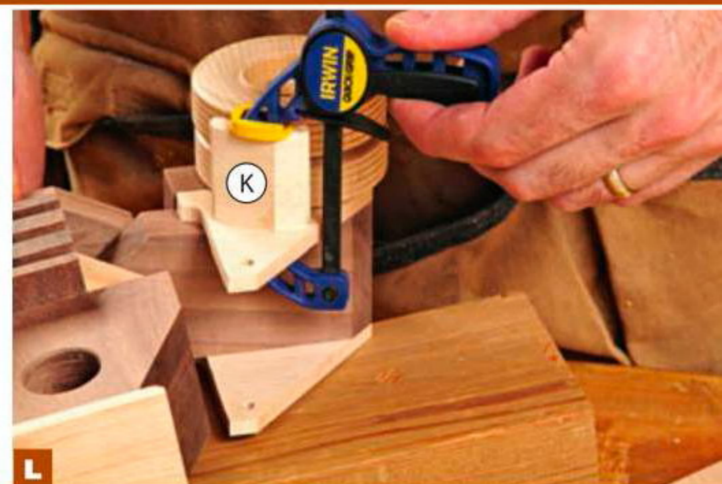
Выровняйте среднюю часть задних крыльев J параллельно верху капота В, отступив вниз 30 мм. Места приклеивания передних крыльев К указаны на шаблоне опорных стоек.
