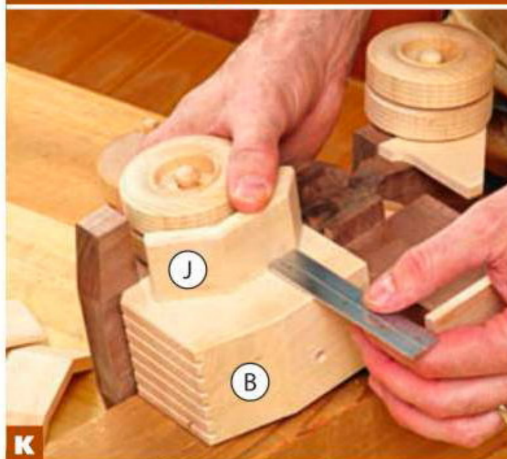
Выровняйте среднюю часть задних крыльев J параллельно верху капота В, отступив вниз 30 мм. Места приклеивания передних крыльев К указаны на шаблоне опорных стоек.
