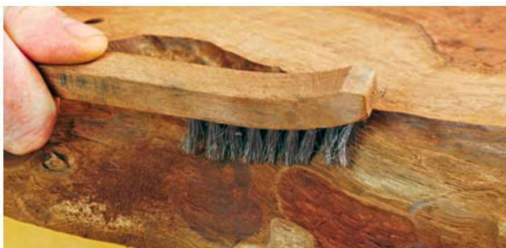
Удалив кору, небольшой нейлоновой или стальной щеткой нужно счистить слабо держащиеся волокна камбия.
