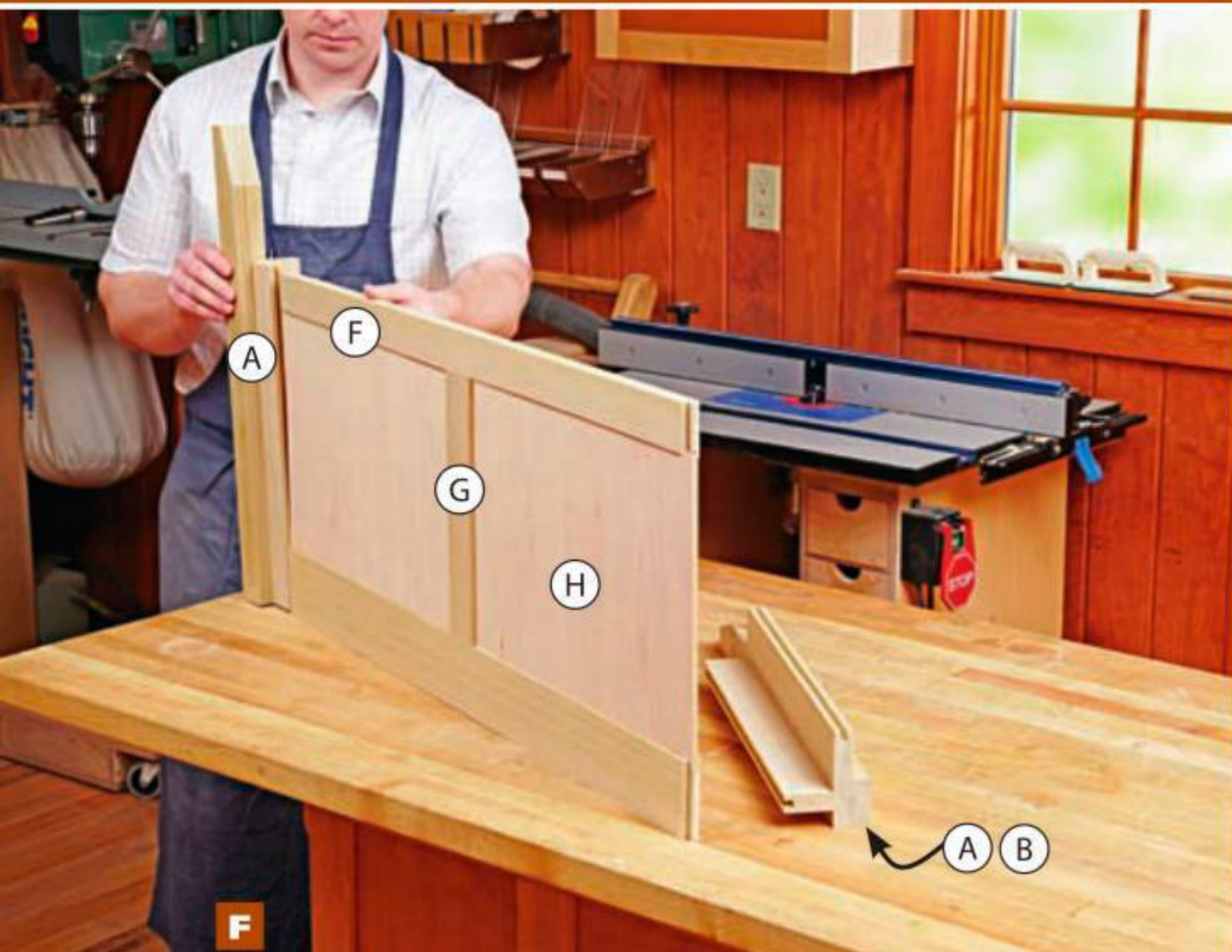
Верхние торцы ножек А и верхние кромки перекладин Е проще выровнять, если собирать корпус перевернутым.
