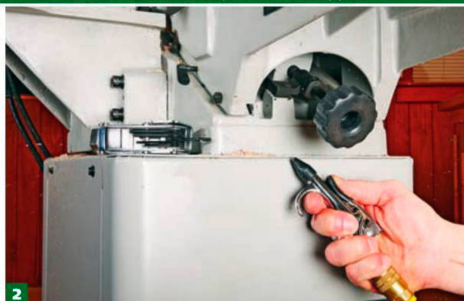
2 Приподнимите край стола, чтобы смазка проникла во все места. Удалите старую смазку и грязь струей сжатого воздуха из компрессора.
